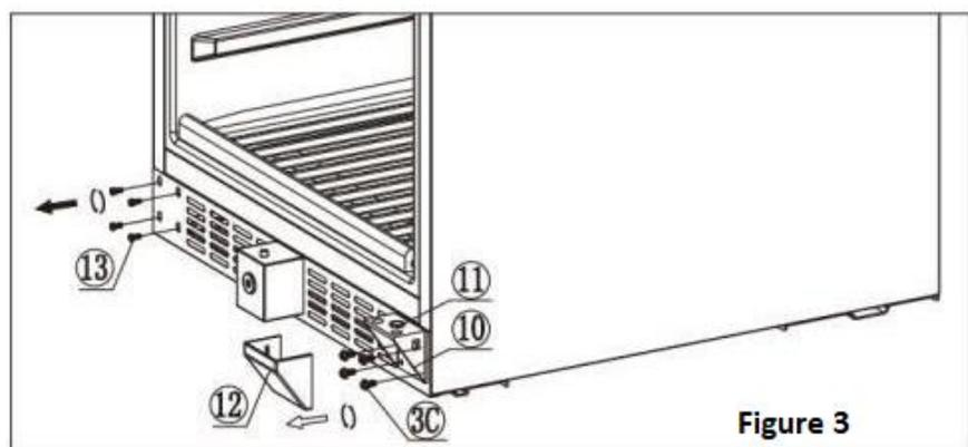
**3.** À l'aide d'un tournevis à tête plate, soulevez le couvercle de la charnière inférieure (12). À l'aide d'un tournevis à tête Phillips, desserrez et enlevez les vis (3c) et (13) et la charnière inférieure (10).
