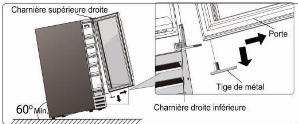
**3.** Utilisez un petit tournevis à tête plate pour soulever et enlever le capuchon en plastique sur le centre supérieur (trou de verrouillage) de la porte et insérez-le dans le trou central inférieur, Faites une rotation de 180 degrés (sens antihoraire) avec la porte de façon à ce que le haut devienne le bas.
