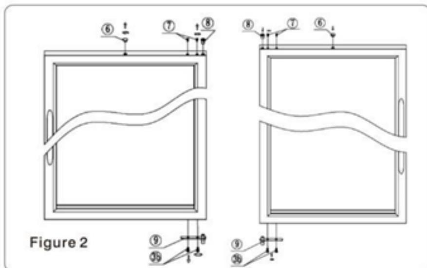
**2.** À l'aide d'un tournevis à tête Phillips, desserrez les vis (3b) pour retirer la tige de métal de la charnière (9) au bas de la porte. Tournez la porte à 180° (dans le sens horaire) de sorte que le haut est maintenant le bas et vice versa. Fixez la tige de métal de la charnière inférieure (9) au coin inférieur de la porte et fixez-la à l'aide des vis (3b).
