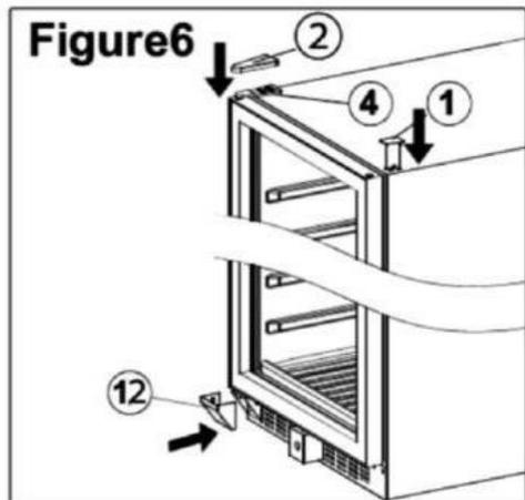
**6.** Replacez la charnière supérieure (4) à l'aide des vis (3a). Insérez le capuchon de verrouillage (6), les vis (7) et (8) et fixez le capuchon de la charnière (2). Remettez le couvercle de charnière (1) et le couvercle de la charnière inférieure (12).
