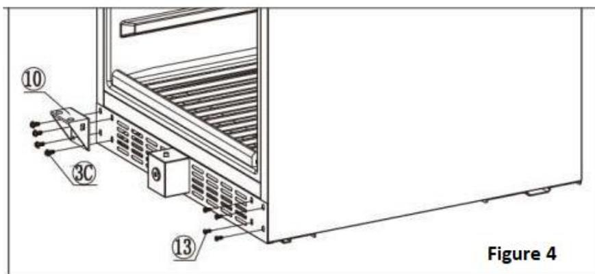
**4.** Déplacez la charnière inférieure (10) du côté opposé et réinsérez toutes les vis (3c) et (8). Le couvercle de la charnière inférieure (12) doit se rabattre sur la charnière inférieure (10).
