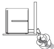
2. Utilisez un conduit d'évacuation métallique rigide de 4" (10,2 cm). Scellez tous les joints à l'aide d'un ruban en aluminium, y compris au niveau du sèche-linge. N'utilisez jamais de vis, qui entraînent l'accumulation de peluches.
