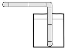
4. Nettoyez tous les anciens conduits avant d'installer votre nouveau sèche-linge. Vérifiez que le clapet d'air s'ouvre et se ferme sans problème. Inspectez et nettoyez le système d'évacuation une fois par an.
