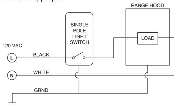
4. Installer l'interrupteur d'éclairage à bascule unipolaire à la boîte d'interrupteur.
