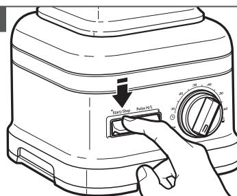
Si le mélangeur reste en mode attente pendant 10 minutes sans activité, il se met en mode veille. Pour sortir du mode veille, appuyer sur le bouton START/STOP (mise en marche/arrêt) une fois, le mélangeur se mettra en mode attente. Appuyer de nouveau sur START/STOP (mise en marche/arrêt) pour mettre le mélangeur en marche.
