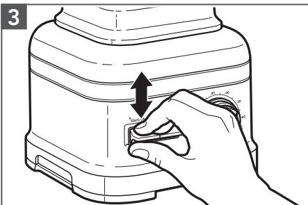
Faire basculer l'interrupteur START/STOP (mise en marche/arrêt) vers le haut ou le bas pour commencer à faire fonctionner le mélangeur. Le témoin lumineux est maintenant allumé.
