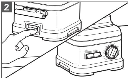
L'interrupteur d'alimentation principal est situé à l'arrière du socle du mélangeur. Basculer l'interrupteur en position I (marche). Le témoin d'alimentation situé au dessus de l'interrupteur de marche à bascule commence à clignoter, ce qui indique que l'appareil est en mode attente. Le mélangeur est maintenant prêt à l'utilisation.
