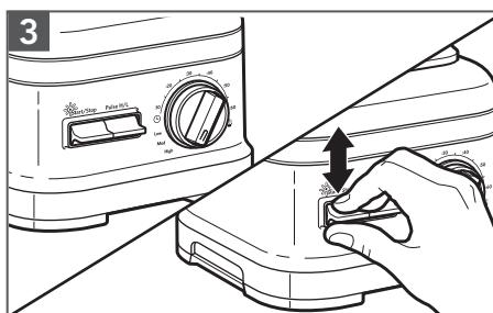
Faire tourner le bouton de commande sur 30 secondes. Faire basculer l'interrupteur START/STOP (mise en marche/arrêt) vers le haut ou le bas. Une fois la durée terminée, vider l'eau savonneuse et rincer le récipient à l'eau tiède.
