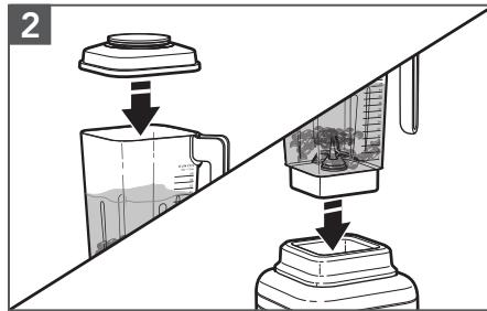
Asegúrese de que la tapa esté completamente asegurada sobre la jarra de la licuadora; después, coloque la jarra de la licuadora sobre la base y asegúrese de que esté perfectamente alineado sobre la base de la jarra.
