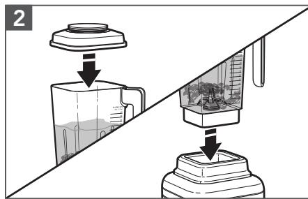
Vous assurer que le couvercle est bien positionné sur le récipient; placer ensuite le récipient sur le socle en vérifiant qu'il est bien aligné sur le capuchon inférieur.
