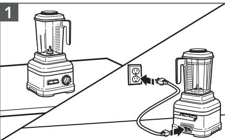
Avant d'utiliser le mélangeur, s'assurer que le comptoir situé sous et près du mélangeur est sec et propre. Vérifier que le commutateur d'alimentation situé derrière la base du mélangeur est fermé (O) et que le cordon est bien branché au dos du mélangeur. Brancher ensuite le mélangeur sur une prise à 3 alvéoles reliée à la terre.
