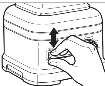
Après avoir mélangé, faire basculer l'interrupteur START/STOP (mise en marche/arrêt) vers le haut ou le bas. Permettre au mélangeur d'arrêter complètement avant d'enlever le couvercle et de verser les ingrédients.
