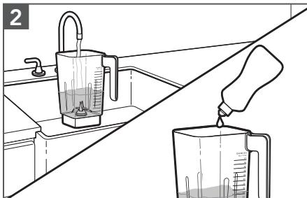
Asegúrese de limpiar la jarra de la licuadora, la tapa y la tapa para ingredientes después de cada uso. Retire todo contenido restante de la jarra de la licuadora. Llene la jarra de la licuadora con 2 tazas de agua tibia y 1 gota de detergente líquido. Coloque la tapa en la jarra de la licuadora y asegúrese de que la jarra esté completamente en su lugar sobre la base.
