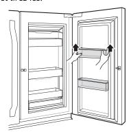
Pour replacer les paniers de la porte, faites-les glisser au-dessus de leur support et appuyez jusqu'à ce qu'ils se mettent en place.
