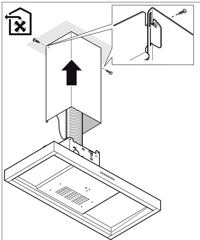
4 Poser le capot de cheminée inférieur sur l'appareil.
