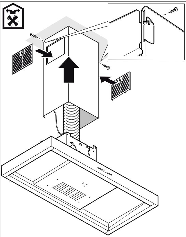
Écarter légèrement les deux tôles latérales, les accrocher derrière le capot de cheminée supérieur et les presser jusqu'en butée.
