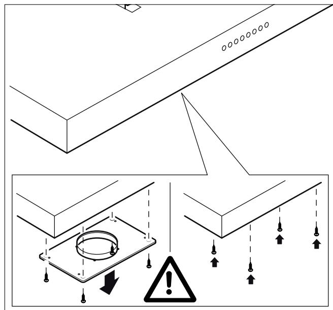
Introducir el motor del ventilador desde arriba en la campana extractora. Fijar con 4 tornillos.
