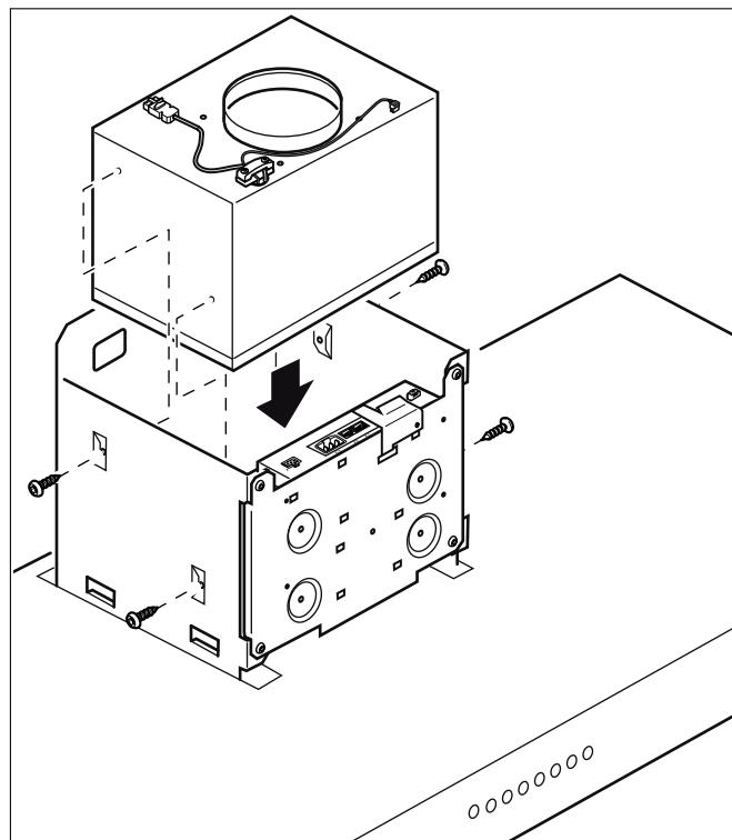
Raccordez le câble secteur et le câble de commande au module de commande.
