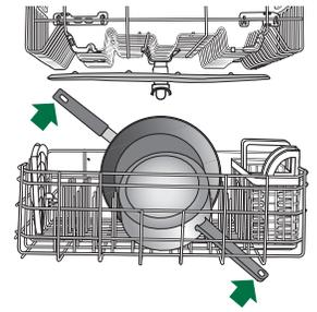
Les bras d'aspersion peuvent être bloqués par des articles qui dépassent du panier. Veiller à ce qu'ils ne bloquent pas les bras d'aspersion supérieur ou inférieur.
