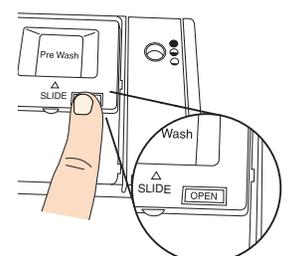
Verser le détergent sélectionné dans le distributeur. Placer votre doigt comme illustré et faire glisser la porte pour la fermer. Appuyer fermement jusqu'à ce qu'un déclic se fasse entendre.
