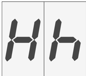
La placa de cocción cuenta con un indicador de calor residual en cada zona de cocción que muestra cuáles aún están calientes. Debe evitar, por tanto, tocar la zona de cocción que muestre esta indicación.
