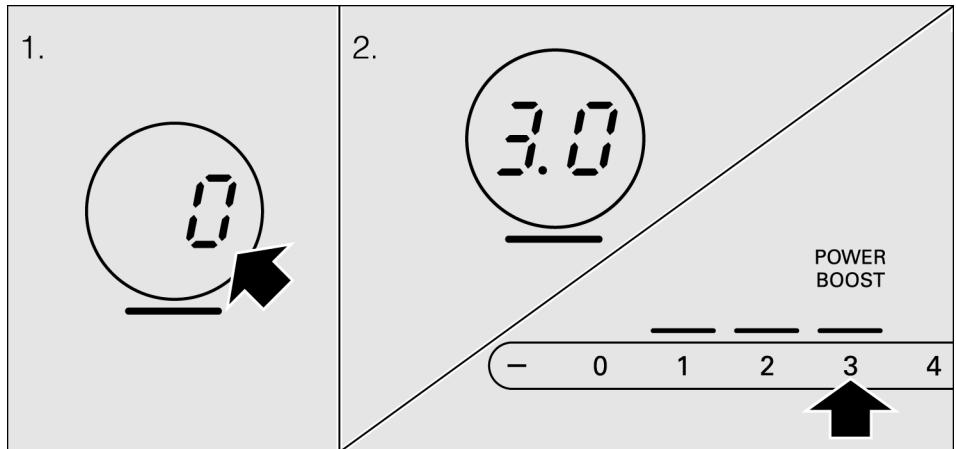
3. Modificar la posición de cocción: Seleccionar la zona de cocción y cambiar la posición de cocción con los símbolos de 1 a 9 o con los símbolos + y -.
