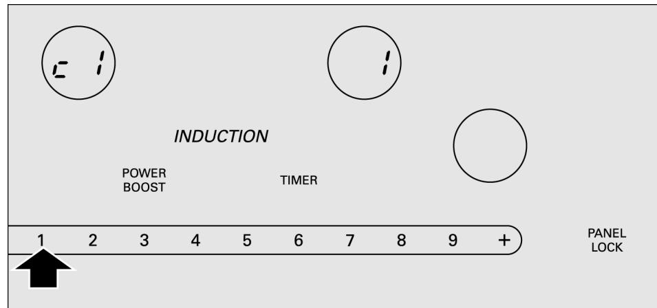
5. Appuyer à nouveau sur le symbole **PANEL LOCK**, pendant plus de 4 secondes, jusqu'à ce qu'un signal de confirmation soit émis. Les réglages ont été correctement sauvegardés.
