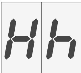
La surface de cuisson est dotée d'un indicateur de surface chaude pour chaque élément. L'indicateur signale les éléments dont la surface est encore chaude. Vous devez donc éviter de toucher à la surface de cuisson lorsque l'indicateur est activé.
