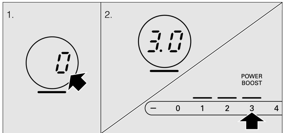
3. Modifier la position de chauffe : sélectionner la zone de cuisson et modifier la position de chauffe avec les symboles 1 à 9 ou + et -.
