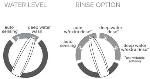
Régler le bouton Water Level (niveau d'eau) pour le réglage Auto Sensing (détection automatique) et la laveuse détecte automatiquement le niveau d'eau appropriée de la taille de la charge et le type.
