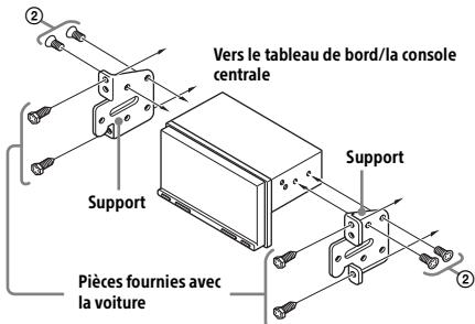
Si vous installez cet appareil sur les supports préinstallés de votre véhicule, faites passer les vis fournies ② par les trous de vis appropriés, en fonction de votre véhicule :
