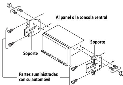
Al montar esta unidad en los soportes preinstalados de su automóvil, use los tornillos ② suministrados en los espacios para tornillos correspondientes según su automóvil: T para TOYOTA y N para NISSAN.
