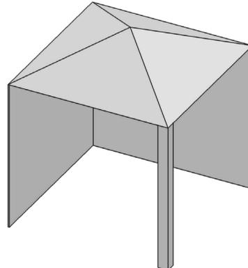
Installation à l'intérieur d'une enceinte partielle qui comprend un recouvrement sur le dessus et trois murs latéraux, dans la mesure où 30 pour cent ou plus de la périphérie horizontale de l'enceinte est ouverte en permanence.
