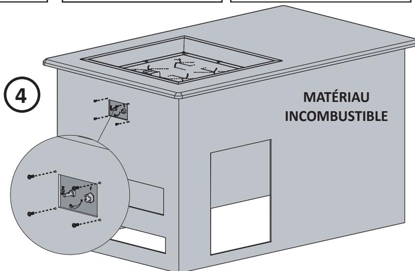
Le centre de la soupape doit être à un minimum de 8" (203 mm) sous la surface supérieure du brûleur.
