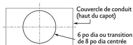
Pour les hottes de 900 et 1200 CFM, la transition (AKVT6810 ou AKVT8812) est installée en standard dans la hotte. Il sera situé exactement au centre de la couverture du conduit (de gauche à droite et d'avant en arrière).
