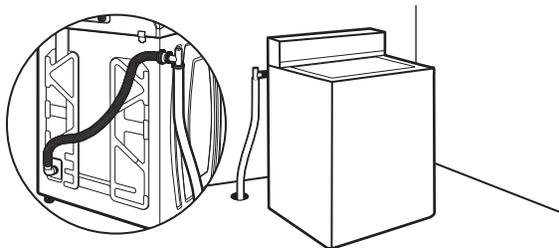
Le système de vidange au plancher nécessite un ensemble de brise-siphon (pièce numéro 285834), deux ensembles de connection (pièce numéro 285835) et un tuyau de vidange supplémentaire (pièce numéro 285863) qui peuvent être achetés séparément. Pour commander, consulter les numéros d'appel sans frais figurant dans le Guide d'utilisation et d'entretien. Dimension minimale pour le brise-siphon : 28" (710 mm) à partir du fond de la laveuse. (Des tuyaux supplémentaires peuvent être requis).
