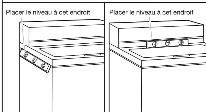
Mettre la laveuse est à son emplacement final. Placer un niveau sur les bords supérieurs de la laveuse. Utiliser une rive latérale comme guide pour déterminer l'aplomb des côtés. Vérifier l'aplomb de l'avant à l'aide du couvercle, tel qu'indiqué. Faire bouger la laveuse d'avant en arrière pour s'assurer que les quatre pieds sont bien en contact avec le plancher. Si la laveuse est d'aplomb, passer à l'étape 3.
