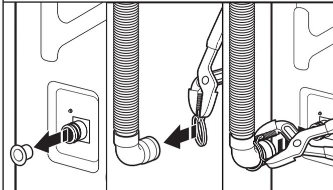
Retirer le bouchon en plastique rouge de l'orifice de vidange noir situé à l'arrière de la laveuse.
