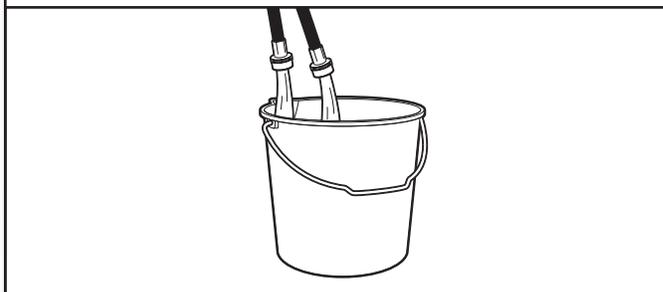
Faire couler l'eau par les tuyaux dans l'évier de buanderie, le tuyau de rejet à l'égout ou le seau pendant quelques secondes pour éviter toute obstruction. On doit laisser couler l'eau jusqu'à ce qu'elle soit limpide.
