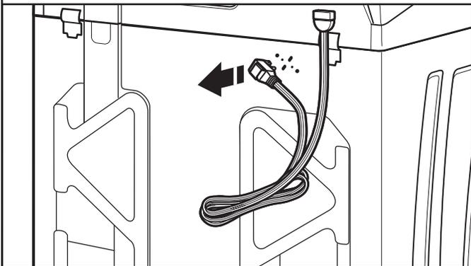
Saisir fermement le cordon d'alimentation et le tirer pour le libérer du panneau arrière. Placer délicatement le cordon d'alimentation par dessus la console pour permettre le libre accès à l'arrière de la laveuse.
