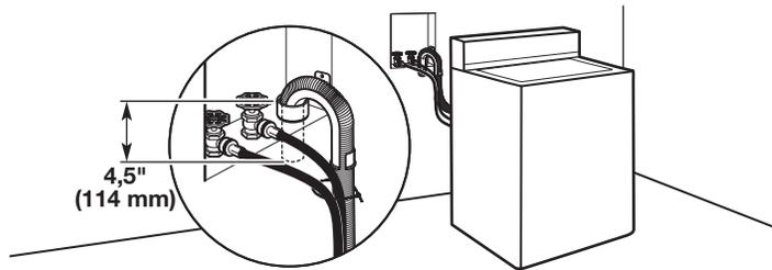
Voir les exigences pour le système de vidange avec tuyau de rejet à l'égout au plancher.
