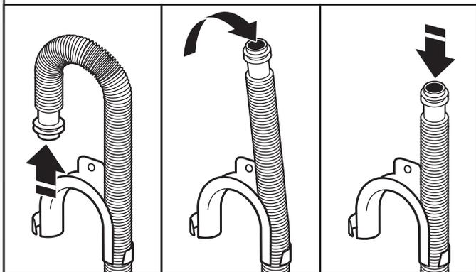
Pour les installations avec vidange au plancher, il faut retirer la bride de retenue pour tuyau de vidange de l'extrémité du tuyau de vidange. Des pièces supplémentaires avec des directives distinctes seront peut-être nécessaires. Voir "Outils et pièces."
