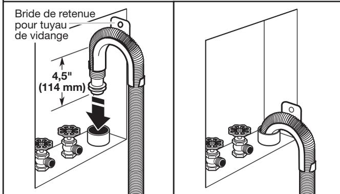
Placer le tuyau dans le tuyau de rejet à l'égout (illustré sur l'image) ou par-dessus le côté de l'évier de buanderie.
