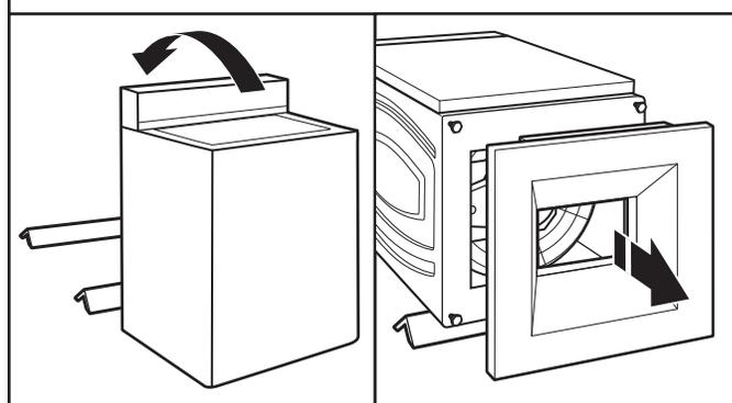
Afin d'éviter d'endommager le plancher, placer les supports en carton du carton d'expédition sur le plancher, derrière la laveuse. Incliner la laveuse vers l'arrière et la placer sur les supports en carton. Retirer la base d'expédition. Redresser la laveuse en position verticale.
