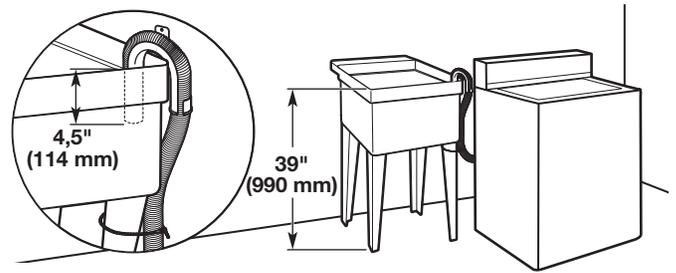
Capacité minimale : 20 gal. (76 L). Le sommet de l'évier de buanderie doit se trouver à au moins 39" (990 mm) du plancher; ne pas l'installer à plus de 96" (2,44 m) du fond de la laveuse.
