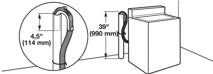
Diamètre minimal pour un tuyau de rejet à l'égout : 2" (51 mm). Capacité minimale d'acheminement : 17 gal. (64 L) par minute. Le sommet du tuyau de rejet à l'égout doit avoir une hauteur d'au moins 39" (990 mm); ne pas l'installer à plus de 96" (2,44 m) du fond de la laveuse. Si on doit l'installer à plus de 96" (2,44 m) de hauteur, un système de pompe de puisard est nécessaire.
