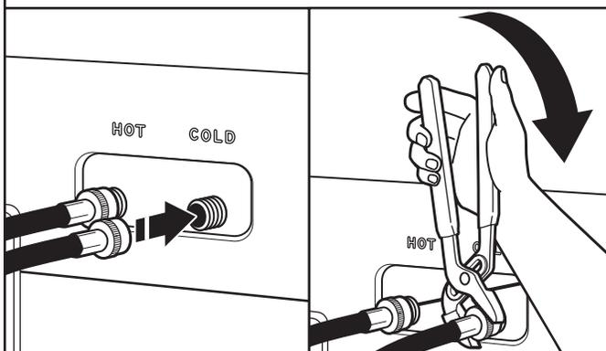
Fixer le tuyau d'eau chaude au robinet d'arrivée d'eau chaude indiquée par une bague rouge. Visser le raccord à la main jusqu'à ce qu'il soit bien serré. Serrer les raccords de deux tiers de tour supplémentaires à l'aide d'une pince. Répéter pour le robinet d'eau froide.
