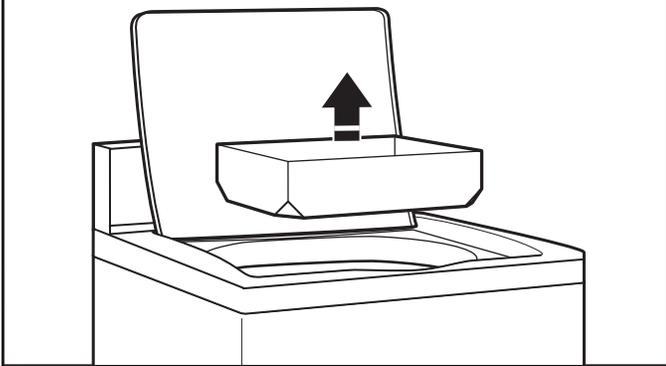
Retirer le ruban adhésif du couvercle de la laveuse, ouvrir le couvercle et retirer le carton plat d'emballage de la cuve. Veiller à retirer toutes les pièces du carton plat.
