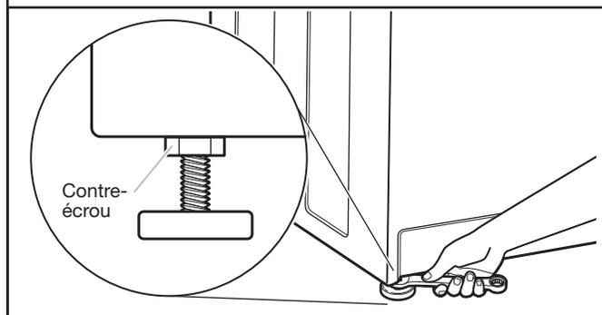
Une fois l'aplomb de la laveuse établi, utiliser une clé plate ou une clé à molette de 9/16" ou 14 mm pour tourner les contre-écrous sur les pieds de nivellement dans le sens anti-horaire et les serrer fermement contre la caisse de la laveuse.
