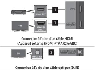
Connexion à l'aide d'un câble optique (D.IN)
