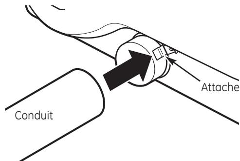
**REMARQUE :** Nous vous recommandons fortement d'utiliser un conduit d'évacuation rigide et en métal. Si vous utilisez un conduit métallique semi-rigide, coupez-le à la bonne longueur et évitez d'écraser le conduit derrière la sècheuse.
