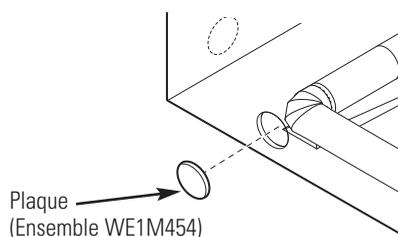
Connectez les coudes et les conduits métalliques pour terminer l'installation du système d'évacuation. Recouvrez l'orifice arrière d'une plaque (Ensemble WE1M454) disponible auprès de votre fournisseur local. Placez la sècheuse à son emplacement final.
