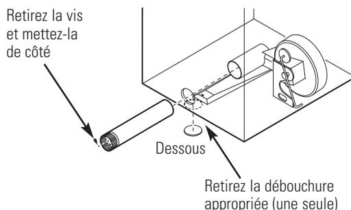
Retirez la vis située à l'intérieur du tuyau d'évacuation de la sècheuse et conservez-la. Retirez le tuyau de la sècheuse. Enlevez la débouchure du dessous.
