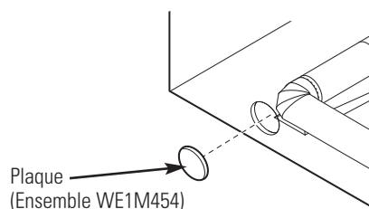
Connectez les coudes et les conduits métalliques pour terminer l'installation du système d'évacuation. Recouvrez l'orifice arrière d'une plaque (Ensemble WE1M454) disponible auprès de votre fournisseur local. Placez la sècheuse à son emplacement final.
