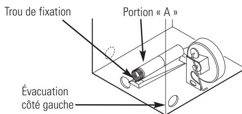
Rebranchez la portion découpée (A) du conduit au boîtier du ventilateur. Veillez à ce que le conduit raccourci soit aligné sur la languette dans la base. Utilisez la vis mise de côté précédemment pour fixer le conduit à la languette sur la base de l'appareil.
