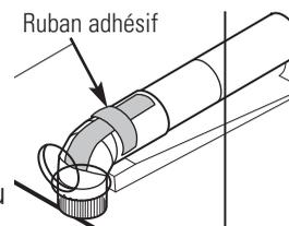
**REMARQUE :** Assurez-vous que le ruban recouvre le trou de vis de la portion A à l'endroit où il se raccorde au coude.
