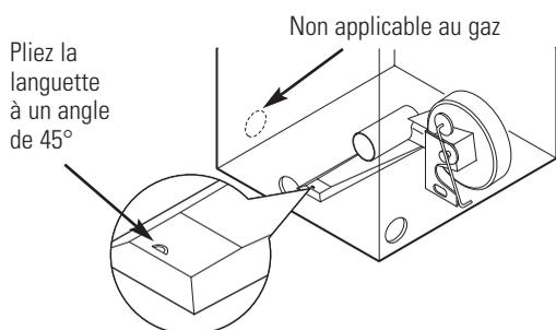
À travers l'orifice arrière, repérez la languette au milieu de la base de l'appareil. Soulevez la languette à 45° à l'aide d'un tournevis à tête plate.
