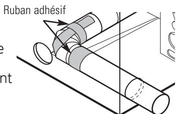
**⚠ MISE EN GARDE** : Les joints du conduit interne doivent être fixés avec du ruban adhésif afin d'éviter qu'ils ne se détachent et que ceci n'entraîne un risque pour la sécurité.
