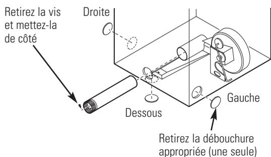
Enlevez la débouchure gauche, droite ou du dessous. Retirez la vis située à l'intérieur du tuyau d'évacuation de la sècheuse et conservez-la. Retirez le tuyau de la sècheuse.
