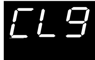
Si le message «CLg» s'affiche à l'écran, il faut nettoyer le conduit d'évacuation avant de terminer l'installation. Vérifiez s'il y a des obstructions ou des restrictions dans le conduit d'évacuation, particulièrement à proximité des coudes. Au besoin, communiquez avec un réparateur qualifié.
