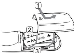
Utilisez des piles AA 1,5 V. Remplacez les deux piles en les insérant dans la télécommande conformément aux instructions indiquées.
