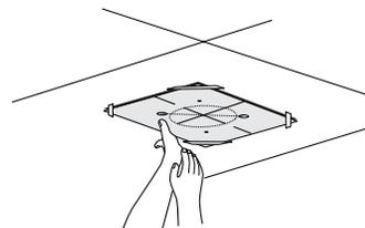
3. À l'aide d'un crayon, marquer au plafond l'emplacement des vis de montage, du point d'accès au câblage et du trou de passage du conduit.
