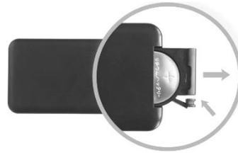
Battery type: 1 x CR2032 / 3V or 1 x CR2025 / 3V
