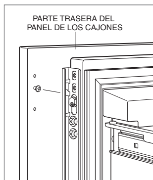
Montaje del panel del cajón.
