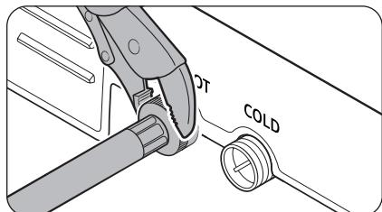
**1.** Branchez les tuyaux d'eau sur les robinets d'eau chaude et d'eau froide, puis serrez à la main les raccords des tuyaux d'eau jusqu'à ce qu'ils soient serrés. Ensuite, utilisez une pince pour serrer les raccords de deux tiers de tour supplémentaires. Pour éviter d'endommager les raccords, ne les serrez pas excessivement.
