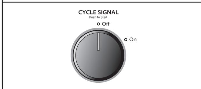
Tourner le bouton Cycle Signal (signal de programme) pour activer ou désactiver le signal. Le signal de programme est un signal sonore qui retentit lorsque le programme de séchage est terminé. Sortir rapidement les vêtements à la fin du programme réduit le froissement.
