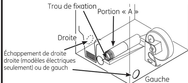
Rebranchez la portion coupée (A) du conduit au boîtier de ventilateur. Assurez-vous que le conduit raccourci soit aligné avec la base de la languette. Utilisez la vis mise de côté précédemment pour fixer le conduit à la languette sur la base de l'appareil.
