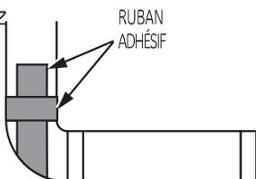
Utilisez un conduit de métal rigide de 4" à l'intérieur de la sècheuse. Les joints internes de conduits doivent être serrés avec du ruban, sans quoi ils peuvent se séparer et provoquer un danger pour la sécurité.
