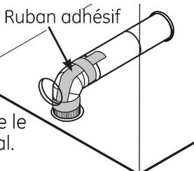
Les joints de conduits internes doivent être scellés avec du ruban adhésif sinon ils peuvent se séparer et provoquer un danger pour la sécurité.
