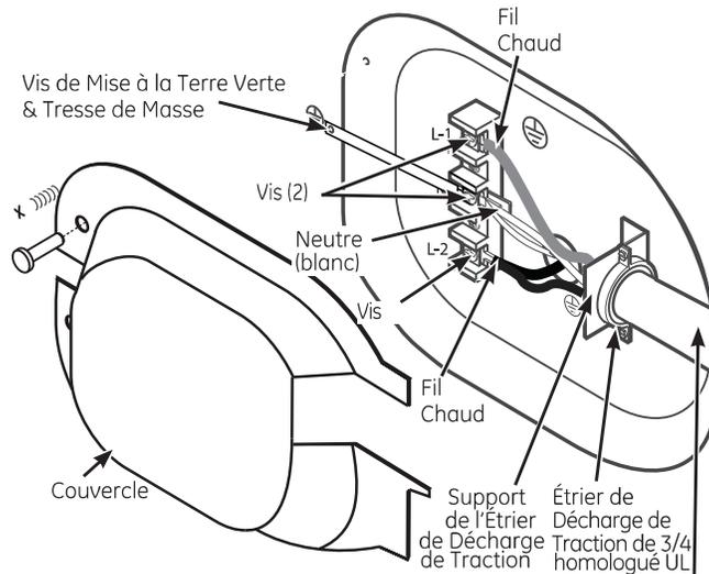
3 conducteurs de cuivre #10 AWG ou l'ensemble de cordon électrique pour sècheuse de 120/240V 30A et des cosses rondes fermées ou des cosses en fourche avec extrémités relevées (non inclus).
