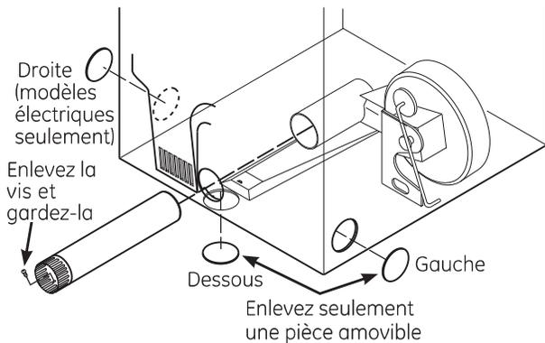
Détachez et enlevez la pièce amovible de droite (seulement sur les modèles électriques), gauche ou dessous. Enlevez la vis à l'intérieur du tuyau d'évacuation de la sécheuse et gardez-la. Tirez conduit hors de la sécheuse.
