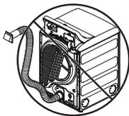
• **NE PAS utiliser un tuyau d'évacuation d'une longueur excessive.** Coupez le conduit le plus court possible.
