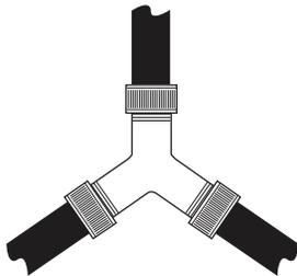
4. Insérez la crépine dans le raccord du joint du tuyau d'arrivée. Si un joint plat en caoutchouc est déjà en place, enlevez-le avant d'installer la crépine. Attachez cet embout à un embout mâle et à l'embout en « Y ». Serrez fermement à la main.
