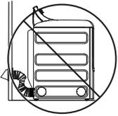
• **NE PAS plier le conduit.** Utilisez des coudes pour les virages si nécessaire.
