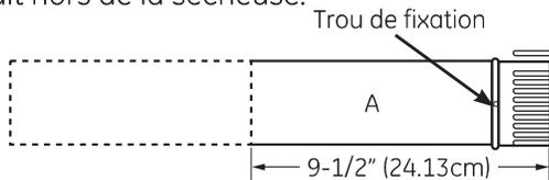
Pour les modèles GTD60, GTD65, GTD68 et GTD75 seulement, utilisez les dimensions ci-dessous.
