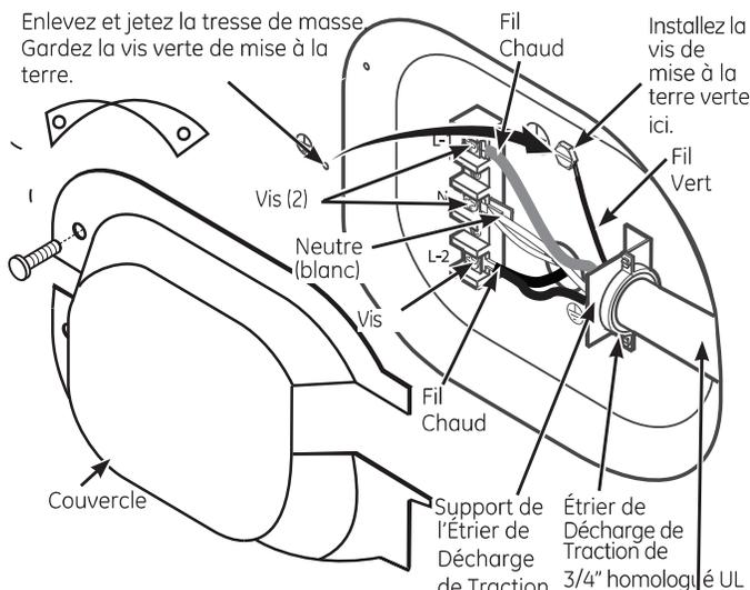
4 conducteurs de cuivre #10 AWG ou l'ensemble de cordon électrique pour sècheuse de 120/240V 30A et de cosses rondes fermées ou des cosses en fourche avec extrémités relevées (non inclus).
