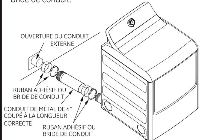
**NOTE :** Nous vous recommandons fortement d'utiliser un conduit d'évacuation en métal rigide. Cependant, si un conduit flexible est utilisé, il doit être de métal homologué UL, et non de plastique.
