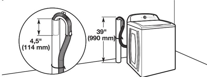
Diamètre minimal pour un tuyau de rejet à l'égout : 2 po (51 mm). Capacité minimale d'acheminement : 17 gal. (64 L) par minute. Le sommet du tuyau de rejet à l'égout doit avoir une hauteur d'au moins 39 po (990 mm); ne pas l'installer à plus de 96 po (2,44 m) du bas de la laveuse. Si l'on doit l'installer à plus de 96 po (2,44 m) de hauteur, un système de pompe de puisard est nécessaire.
