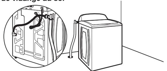
Le système de vidange au plancher nécessite un ensemble brise-siphon (numéro de pièce 285834), deux ensembles de raccordement (numéro de pièce 285835) et une rallonge de tuyau de vidange (numéro de pièce 285863) qui peuvent être achetés séparément. Pour commander, consulter les numéros de téléphone sans frais des instructions d'utilisation de la laveuse. Dimension minimale pour le brise-siphon : 28 po (710 mm) à partir du fond de la laveuse. (Des tuyaux supplémentaires peuvent être requis.)
