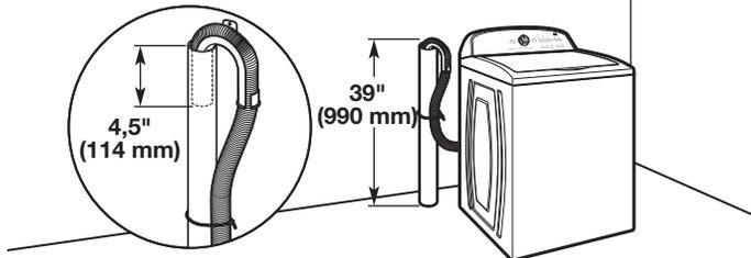
Diámetro mínimo para el desagüe de tubo vertical: 2" (51 mm). Capacidad de desplazamiento mínima: 17 gal. (64 L) por minuto. La parte superior del tubo vertical debe estar a 39" (990 mm) de altura como mínimo; instálela a no más de 96" (2,44 m) de la base de la lavadora. Si debe instalar a más de 96" (2,44 m), necesitará un sistema de bomba de sumidero.
