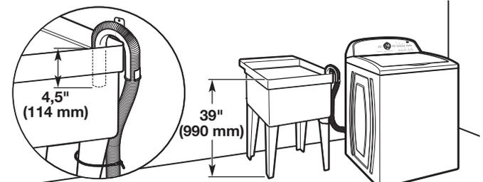
Capacité minimale : 20 gal. (76 L). Le sommet de l'évier de buanderie doit se trouver à au moins 39 po (990 mm) du plancher; ne pas l'installer à plus de 96 po (2,44 m) du fond de la laveuse.
