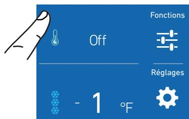
Par exemple, sur l'écran d'accueil, pour réactiver le compartiment réfrigérateur, appuyez sur l'icône OFF.
