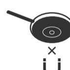
Vous pouvez vérifier la compatibilité d'un récipient de cuisson en en contrôlant le magnétisme à l'aide d'un aimant.
