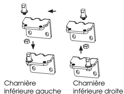
4.3 Installez la charnière inférieure gauche sur le côté gauche du meuble, utilisez les vis de fixation.
