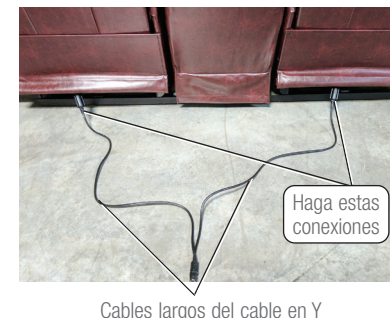
Cables largos del cable en Y
