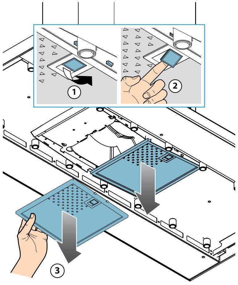
IT - Montaggio filtro carbone attivo di serie: rimuovere filtri metallici (17), montare filtro carbone attivo (18).
