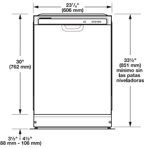
Para un zoco de 100 mm (4"), la altura de la abertura del gabinete es de 863 mm (34 1/2").
