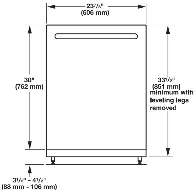
Para un zoco de 100 mm (4"), la altura de la abertura del gabinete es de 863 mm (34 1/2").
