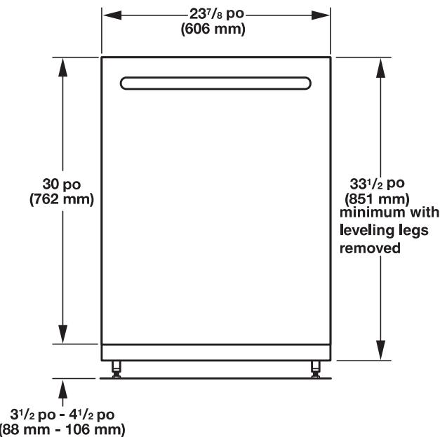
Pour un coup-de-pied de 4 po (100 mm), la hauteur de l'ouverture est de 34 $\frac{1}{2}$  po (863 mm).
