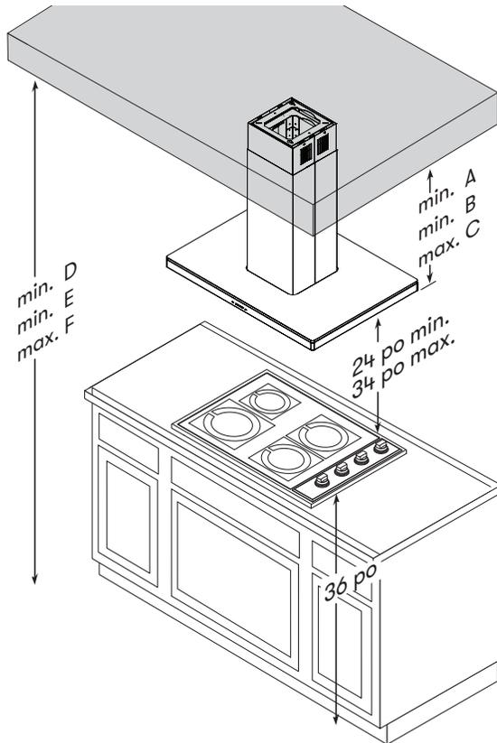
Un conduit rond d'au moins 6 po doit être utilisé pour maintenir une efficacité maximale du débit d'air. Utilisez toujours uniquement des conduits métalliques de type rigide. Les conduits flexibles pourraient restreindre le débit d'air jusqu'à 50 %. Utilisez également le calcul (à la page 8) pour calculer la longueur totale de conduit disponible lors de l'utilisation de coudes, de transitions et de capuchons.
