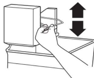
**REMARQUE:** Éteindre la machine à glaçons avant de retirer le bac d'entreposage pour servir des glaçons ou pour nettoyer le bac. Ceci empêchera les glaçons de tomber de la machine à glaçons et dans le compartiment de congélation. Après avoir remplacé le bac d'entreposage, mettre en marche la machine à glaçons.
