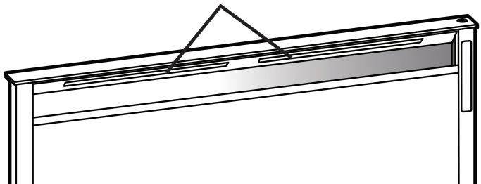
Toucher brièvement l'icône LIGHT (éclairage) sur le panneau de commande pour commander l'éclairage de la partie supérieure de la hotte.
