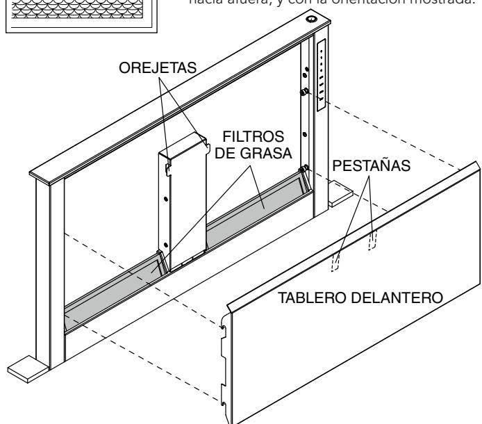
Para retirar el tablero delantero, levántelo y hágalo pivotar hacia fuera en ángulo. El tablero puede retirarse completamente.
