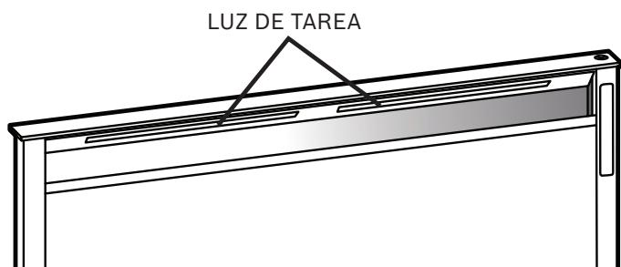
Toque y suelte el ícono LIGHT (luz) del panel de control para ajustar la luz en la parte superior del ventilador.
