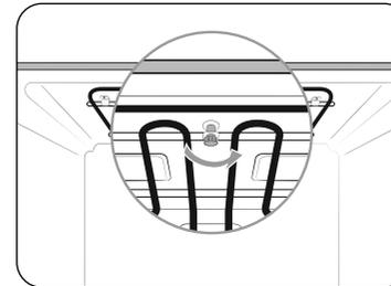
1. Pour remplacer l'ampoule, vous devez incliner la résistance du grill vers le bas. Pour ce faire, tournez l'écrou circulaire sur le support dans le sens antihoraire, tout en maintenant la résistance du grill. La résistance du grill devrait devenir plus lâche et s'incliner vers le bas.
