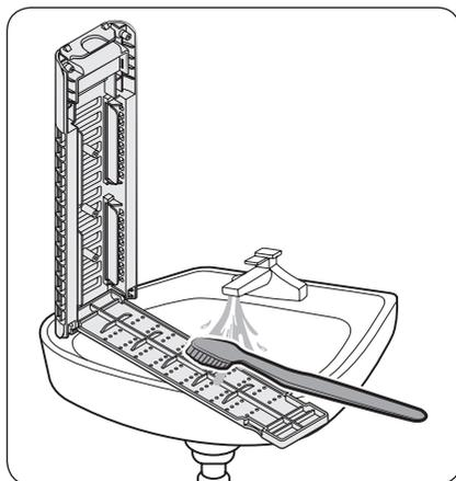
2. Déverrouillez le couvercle et nettoyez le filtre sous l'eau courante à l'aide d'une brosse.
