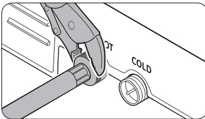
1. Branchez les tuyaux d'eau sur les robinets d'eau chaude et d'eau froide, puis serrez à la main les raccords des tuyaux d'eau jusqu'à ce qu'ils soient serrés. Ensuite, utilisez une pince pour serrer les raccords de deux tiers de tour supplémentaires. Pour éviter d'endommager les raccords, ne les serrez pas excessivement.
