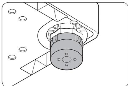
Une fois la bague de pied en place, utilisez le pied de réglage pour ajuster la hauteur du lave-linge.
