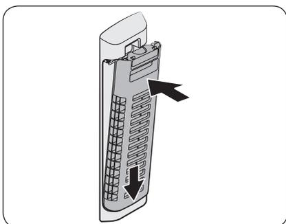
3. Lorsque le nettoyage est terminé, fermez le couvercle et réinsérez le boîtier du filtre sur sa position d'origine. Vous entendrez un clic lorsque le filtre est en place.
