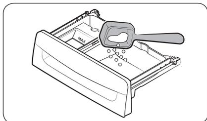
Retirez d'abord le bac à lessive liquide fourni dans le compartiment de lessive. Ensuite, ajoutez de la lessive en poudre dans le compartiment de lessive en respectant les instructions du fabricant de la lessive.
