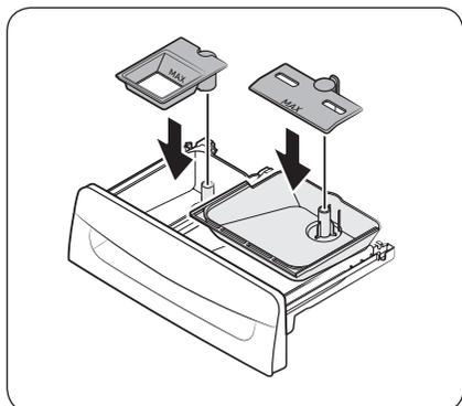
3. Retirez les fixations au niveau des compartiments. Rincez les fixations et le tiroir à l'eau tiède et nettoyez-les à l'aide d'une brosse souple.
