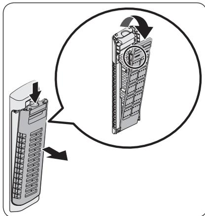
1. Appuyez sur la partie supérieure du boîtier du filtre pour le retirer.
