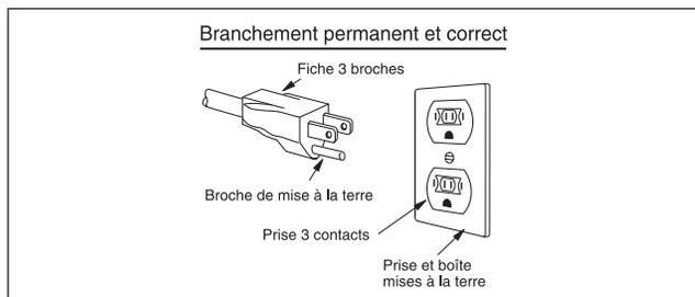
**ATTENTION** - Un mauvais usage de la prise de terre peut causer des chocs électriques. N'employez pas une rallonge. Si le cordon d'alimentation est trop court, demander à un électricien ou un réparateur qualifié de poser une prise près de l'appareil.
