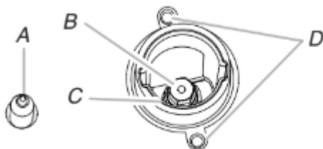
A. Électrode d'allumage B. Injecteur C. Porte-injecteur D. Vis
